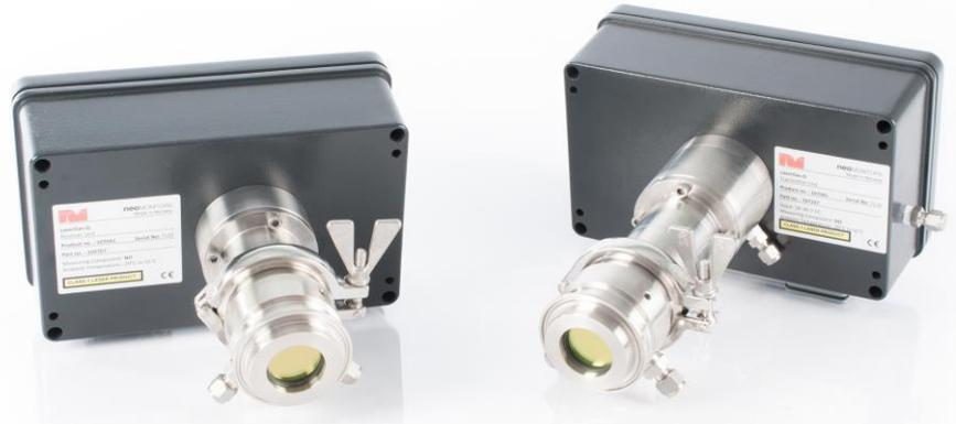
Mit dem **LaserGas™ Q** Spektrometer bietet NEO Monitors ein Messgerät für die kontinuierliche In-Situ-Gasanalyse direkt im Prozessgas an.
